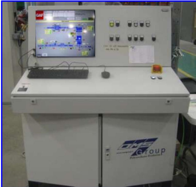
*I quadri elettrici di comando e controllo dei nostri impianti sono sviluppati su processori industriali Siemens di ultima generazione.*
