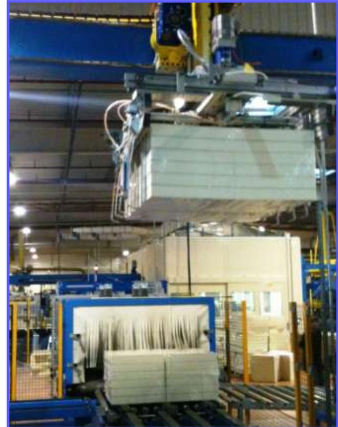
**Unità di sezionatura, di fresatura, impilaggio e imballaggio pannelli**
