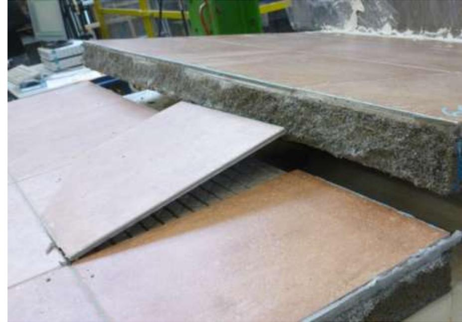
La determinazione del carico ultimo a rottura è stata possibile grazie alla precedente caratterizzazione dei materiali da costruzione (calcestruzzo, acciaio, poliuretano).
