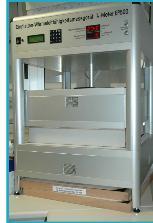
Misura della conducibilità termica UNI EN 12664
