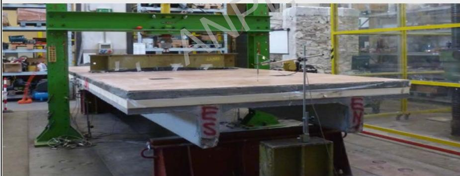
**Figura 8. Prova a flessione del campione alveolare con finitura in piastrelle**
