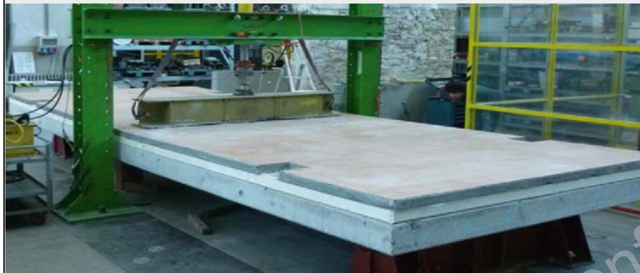
**Figura 7. Prova a flessione del campione tegolo TT con finitura in piastrelle**
