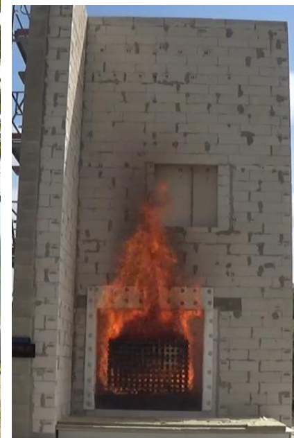
Prove realizzate nel contesto del Progetto Europeo su Facciata in legno, Facciata ventilata in alluminio, Facciata ventilata in ACM
