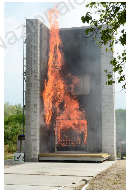
Prove realizzate nel contesto del Progetto Europeo su Facciata in legno, Facciata ventilata in alluminio, Facciata ventilata in ACM
